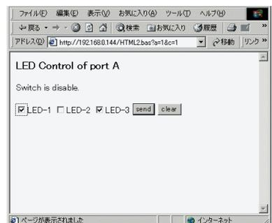
〈写真B〉 写真AのボードとTiny BASICで作ったウェブ・サーバの画面
