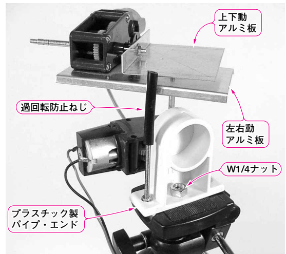
〈写真2〉 カメラ取り付け前の雲台
