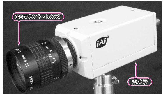
〈写真1〉CSマウント・レンズ取り付け例 [株]ジェイエアイコーポレーション]
