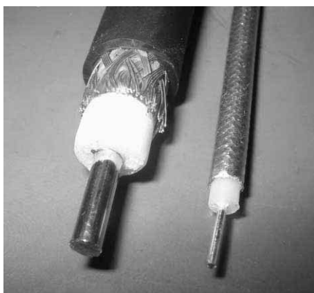
〈写真3-1〉同軸ケーブル(どちらも50Ω)
