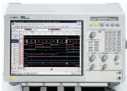
〈写真A〉多数のロジック信号を同時に捕らえて解析できるロジック・アナライザ(第1章～第3章)
