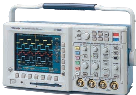
〈写真B〉波形を捕らえて観測できるデジタル・ストレージ・オシロスコープ(第4章～第6章)
