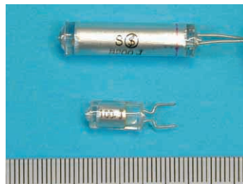
〈写真6〉 スチロール・コンデンサ (現在は生産メーカーなし)
