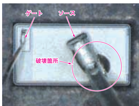
写真 0-3 アバランシェ破壊品(耐圧 60 V)のチップ内部 3
