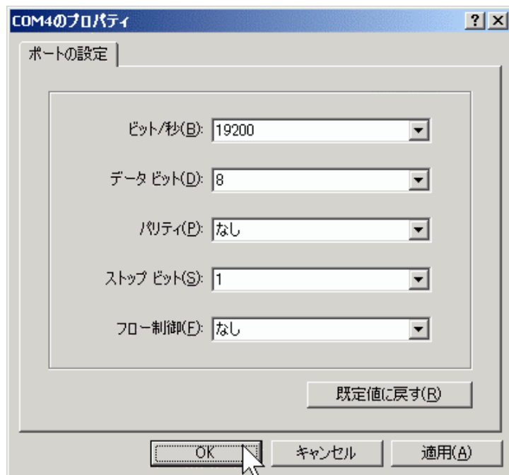
図3 シリアルポート（RS-232Cポート／COMポート）のプロパティ設定画面 この図の通りにパラメータを入力する
