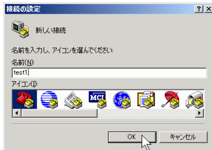
図1 ハイパーターミナルの起動時に表示される接続の設定画面 この例では『test1』という名前を入力している。
