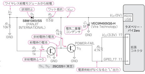
図1 電気二重層コンデン サをバックアップ電源にしたUPS回路
